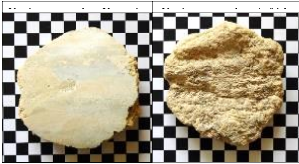
Abbildung 21: Feste Versinterungsprobe aus der südlichen Ulmendrainage auf 1 x 1 cm Raster [24].
