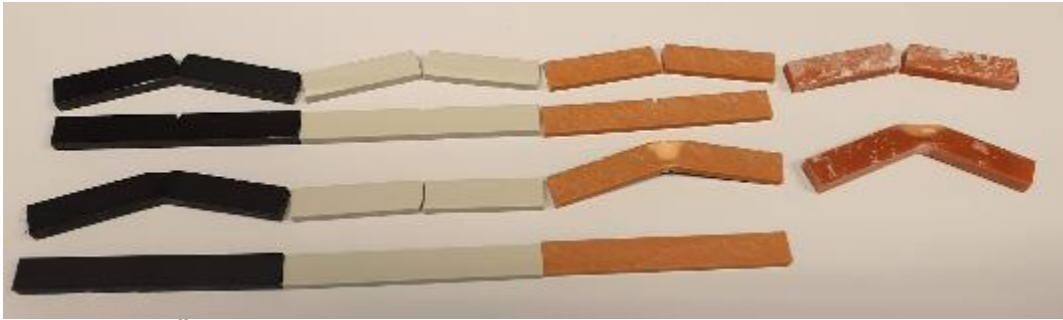
Abbildung 6: Übersichtsbild der untersuchten Schlag- und Kerbschlagversuche an Material aus Platten, sowie direkt aus den Bruchstücken der Rohrwand der Drainagerohe im Tunnel Sieberg entnommen.
