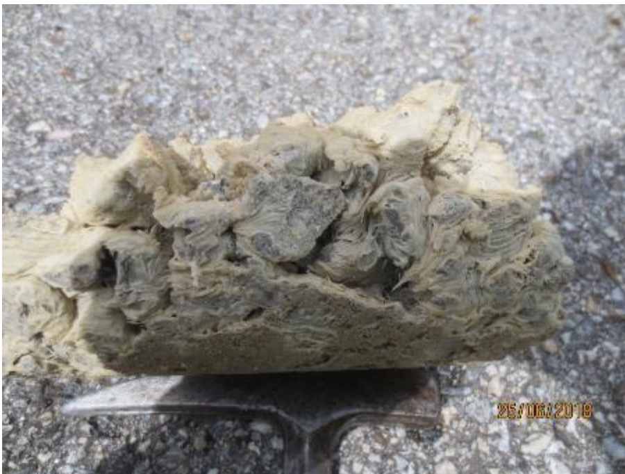
Abbildung 34: Ausbau des Spritzbetons aus dem Drainage-Prüfstand aufgrund starker Zementation durch karbonatische Versinterung
