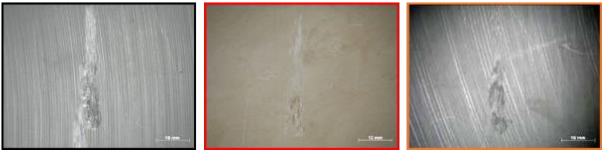
Abbildung 10: Kettenschleuderbeständigkeit derzeit verwendeter Rohrmaterialien (direkt aus Rohrwand DN250 Rohr entnommen): schwarz PE, rot uPVC und orange PP.
