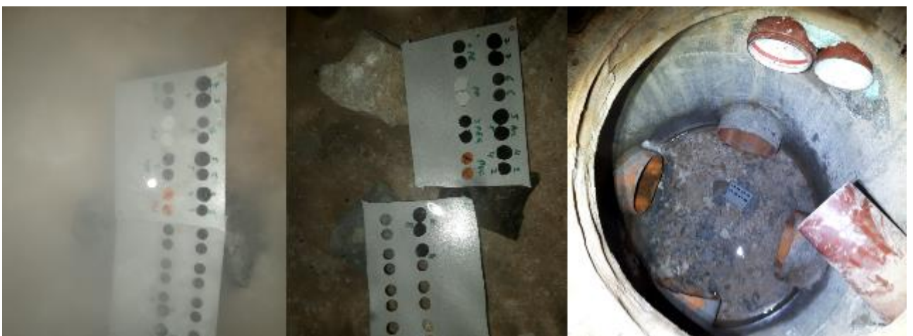
Abbildung 53: Monitoring des Bergwassers in den Schächten der Sammelleitung mit Datumsangabe der Messung. Oben: pH-Wert. Mitte: Elektrische Leitfähigkeit. Unten: Temperatur. Lage von PS04 und PS07 siehe Abbildung 52.
