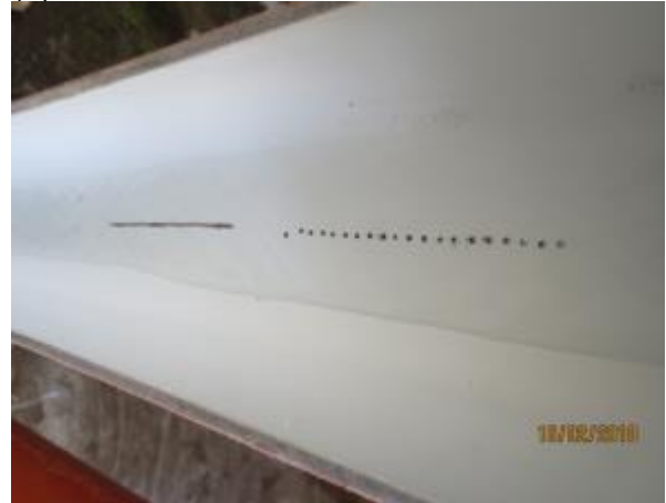
Abbildung 32: Inbetriebnahme des Drainage-Schlitz-Prüfstands durch IB-Strobl (a) und Einbringung unterschiedlicher Drainage-Schlitz Geometrien (b)
