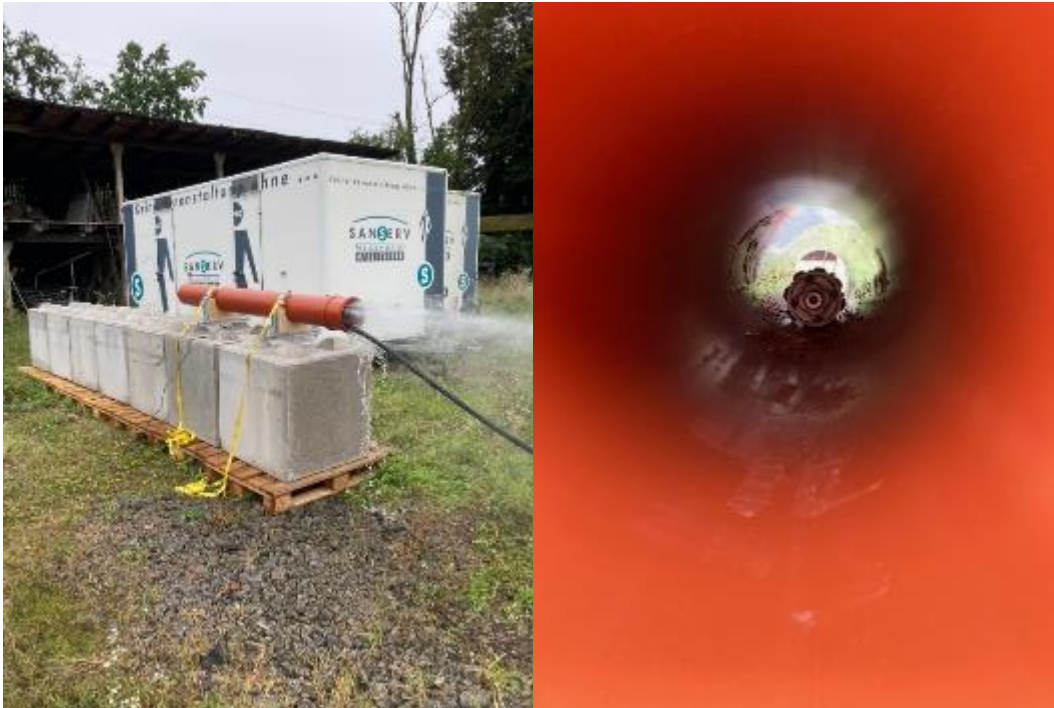
Abbildung 65: Entwickler Prüfstand zur Bestimmung der auftretenden Kräfte bei Spülvorgängen in Drainagerohren
