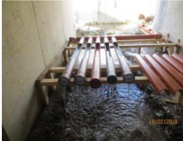
Abbildung 32: Inbetriebnahme des Drainage-Schlitz-Prüfstands durch IB-Strobl (a) und Einbringung unterschiedlicher Drainage-Schlitz Geometrien (b)
