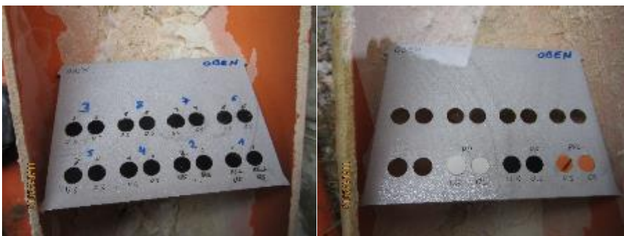
Abbildung 36: Einbau der neu entwickelten Kunststoffmischungen als gestanzte Proben (Durchmesser 10mm) in Stahlhalterung (a) und verschiedener kommerzieller Kunststoffe (b) am Drainageausgang des Tunnels Steinhaus
