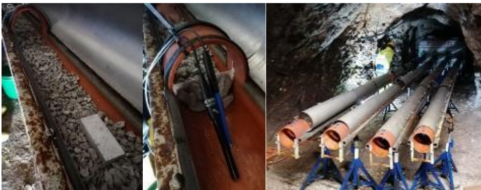
Abbildung 60: Links: Auslagerung der Spritzbetonbruchstücke; Mitte: In-situ Messung nach der Schwelle; Rechts: Foto der Sinterstrecke [27].
