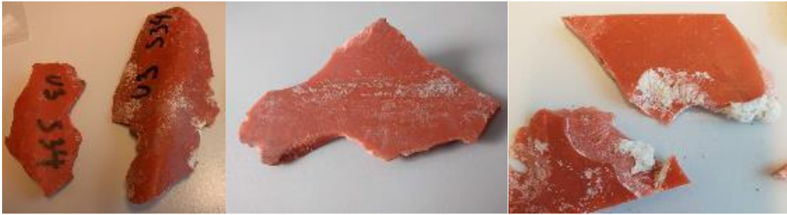
Abbildung 2: Ausgeschlagene Teilstücke der Drainagerohre im Tunnel Sieberg [6]
